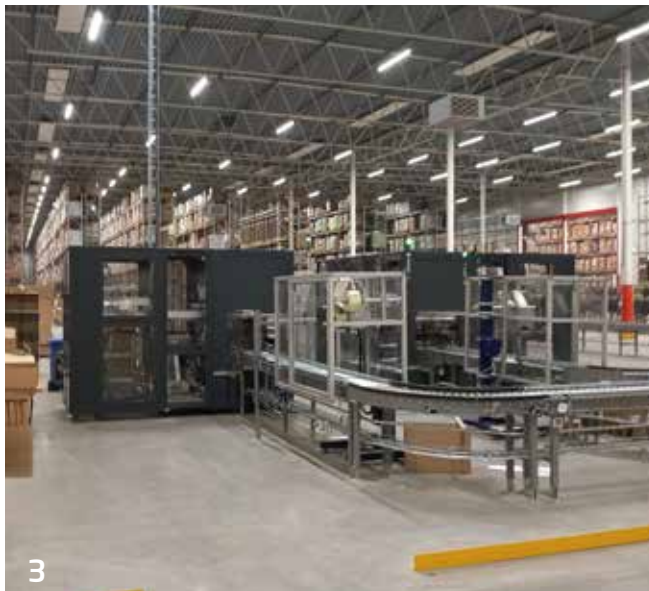
Bild 1 och 2: Tre maskiner som reser lådor i två olika bredder. Bild 3: Maskiner för nedskärning av lådformat, tillsammans med magasin för lock. Bild 4: Färdiga förpackningar, i storlekar exakt anpassade till innehållet.
