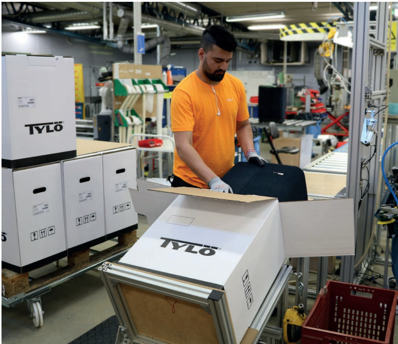
Liggande inpackning i lådor med självlysande topp och botten. Den färdigpackade lådan ställer sig automatiskt på högkant.
