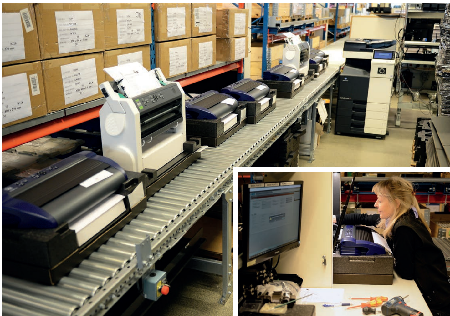
Monteringen börjar direkt i förpackningen. Efter test kommer huven av wellpapp. Allt avklarat utan manuella lyft.
